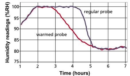
在经过100%相对湿度的一段时间后,加热探头能够测量真实的湿度,而非加热探头则需要较长时间从结露中复。
